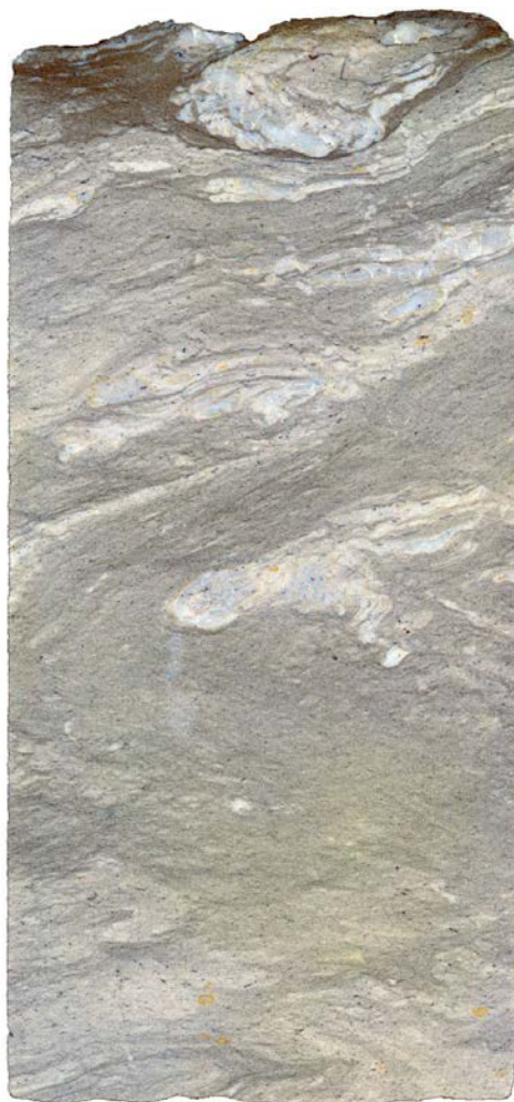
Фото 7. Деформированный слой, залегающий между слабонарушенными пластами и подводно-оползневая складчатость
