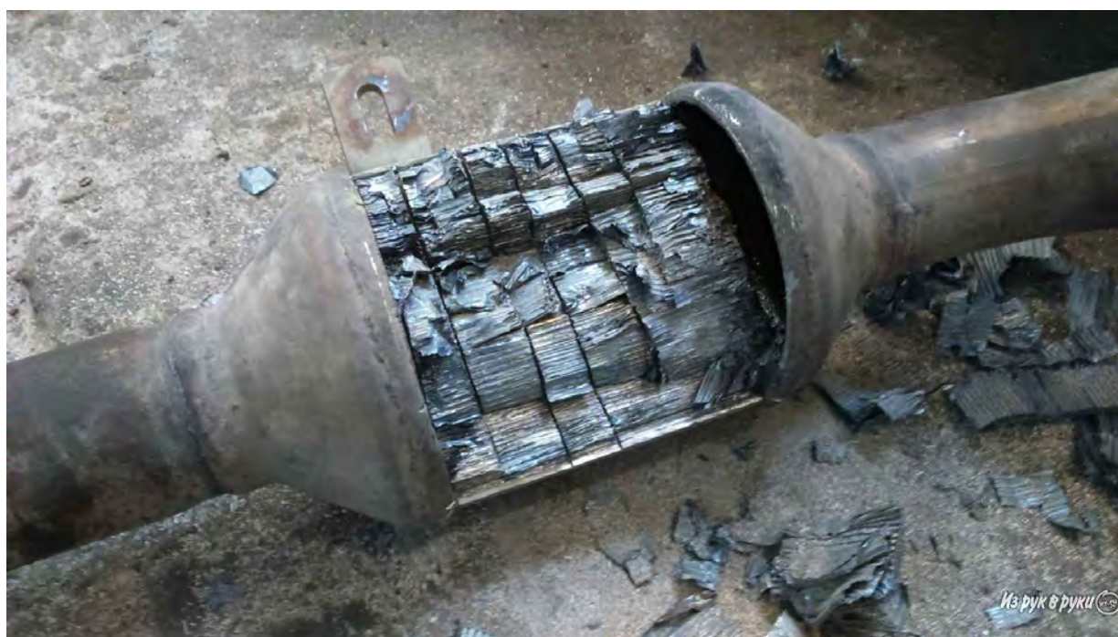
Фото 1. Так выглядит автомобильный катализатор [5]
