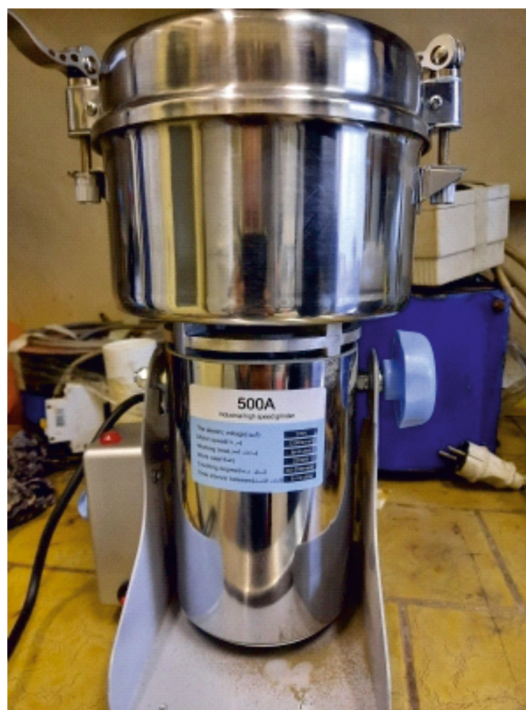
Рис. 1. Рабочая лабораторная модель планетарной мельницы (3-5 тысяч оборотов в минуту)
