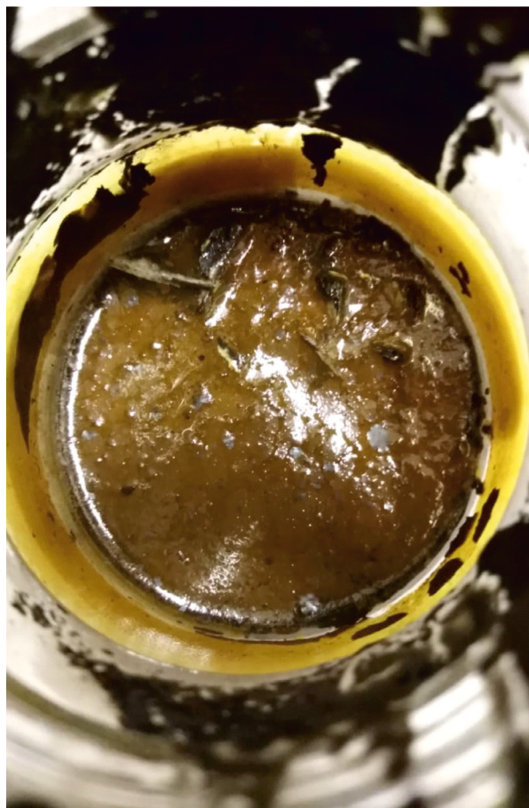
Рис. 6. Концентрат «плывущего» золота перед его обработкой методом лазерной агломерации. Для фракции характерна значительная примесь теллура (Au -72,37%, Te – 27,23% с незначительной примесью меди). Месторождение Петух
